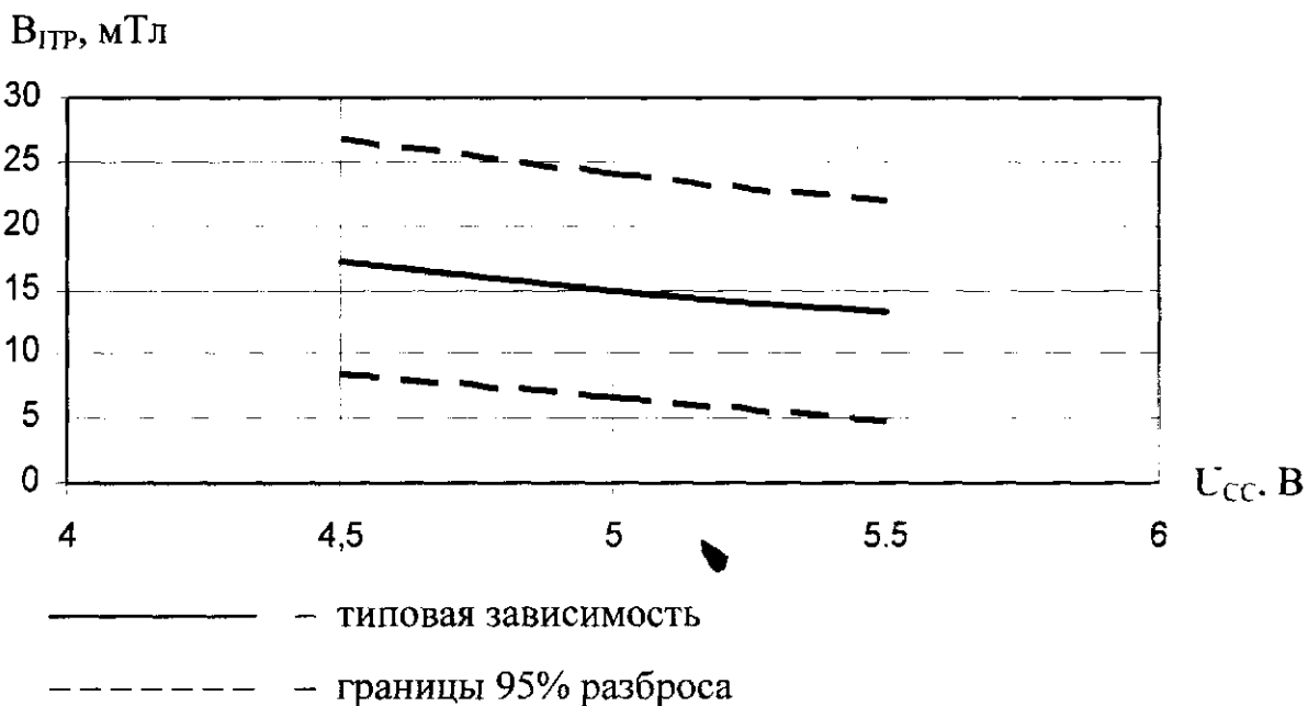
Рисунок 9 – Типовая зависимость индукции срабатывания V_{IPR} от напряжения питания U_{CC} при температуре среды T_{amb} = 25\text{ }^{\circ}\text{C}
