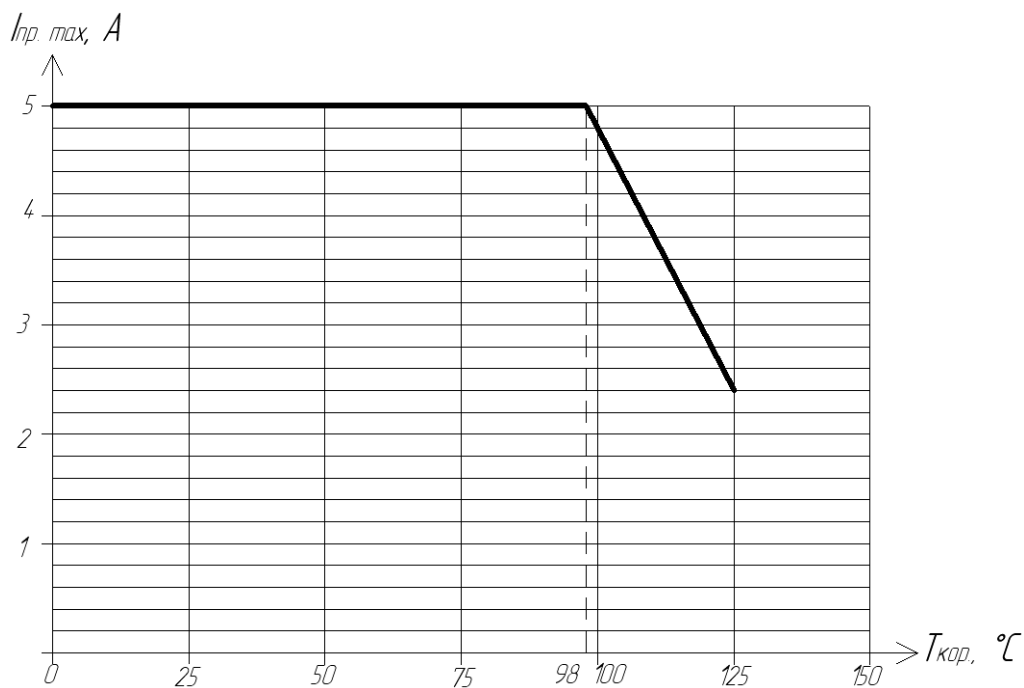
Рисунок 5 – Типовая зависимость максимального постоянного прямого тока одного диода I_{пр. max} от температуры корпуса T_{кор} диодных сборок 2Д2136АС, 2Д2137АС
